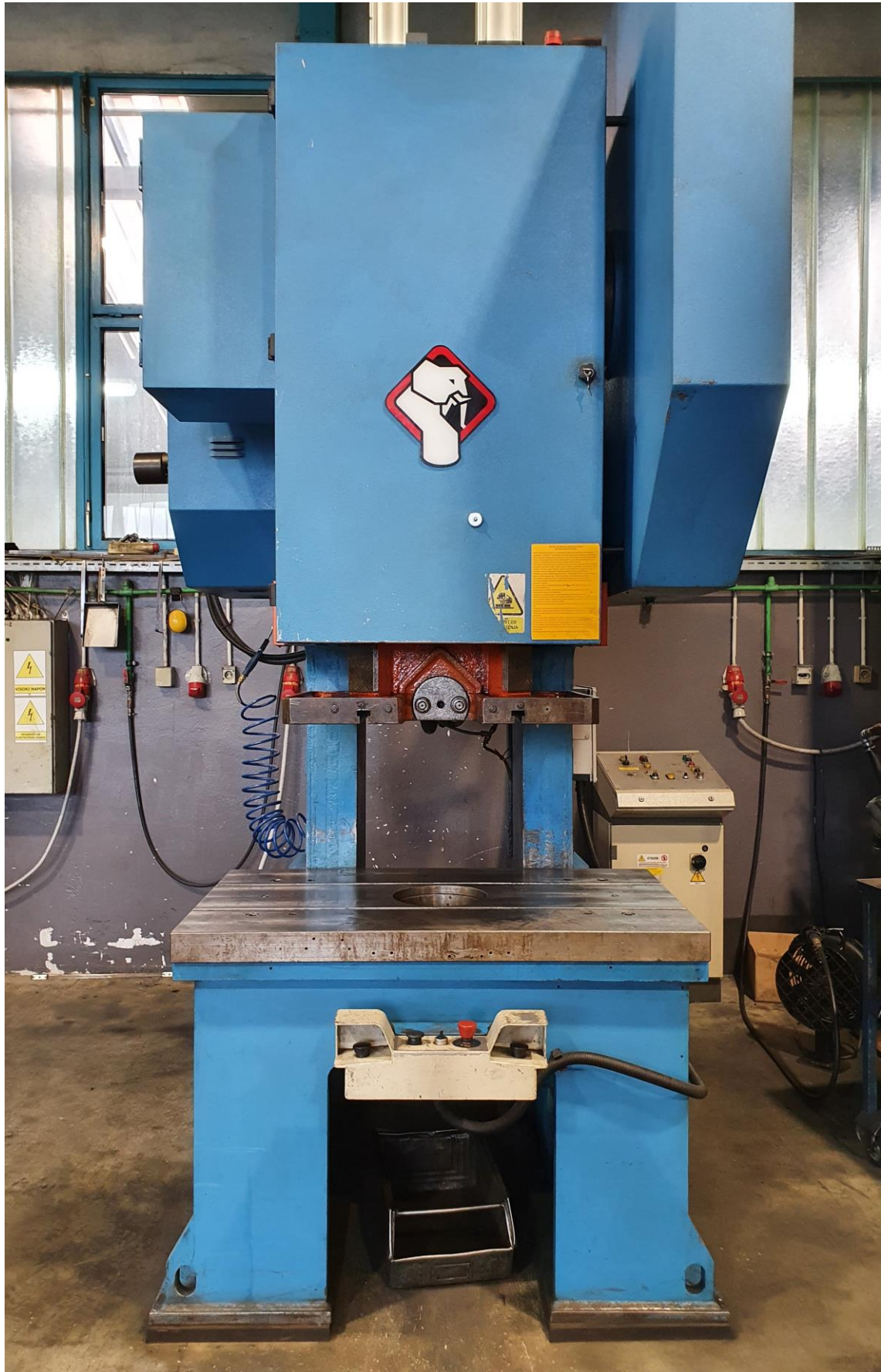
Slika 11.3 Preša Sangiacomo 1300 kN
