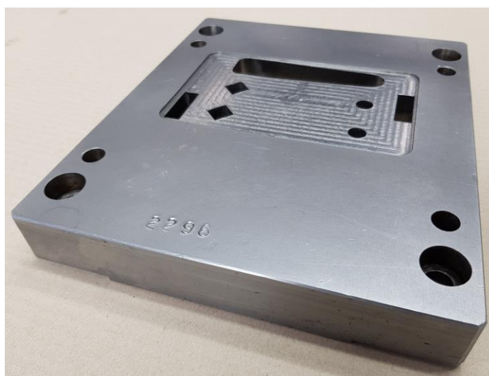
Slika 10.5 3D model vodeće ploče
