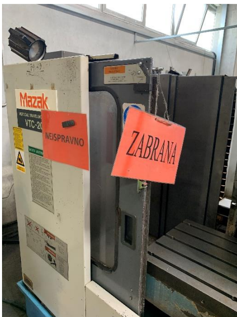
Slika 43. Zabrana korištenja neispravne CNC glodalice
