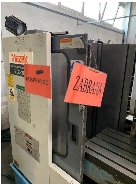
Slika 43. Zabrana korištenja neispravne CNC glodalice
