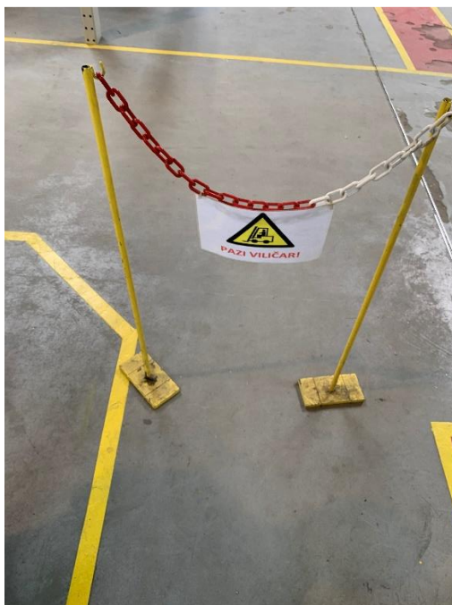
Slika 41. Pomična ograda sa upozorenjem na kretanje viličara
