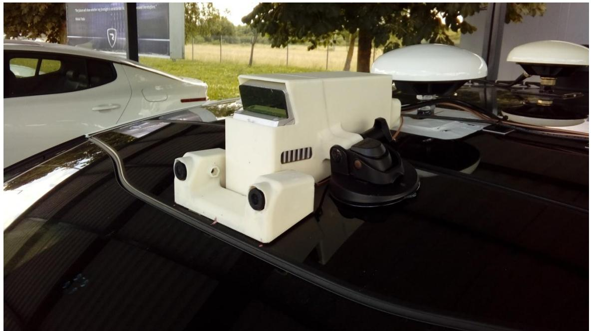
Slika 13: 3D isprintano kućište senzora
