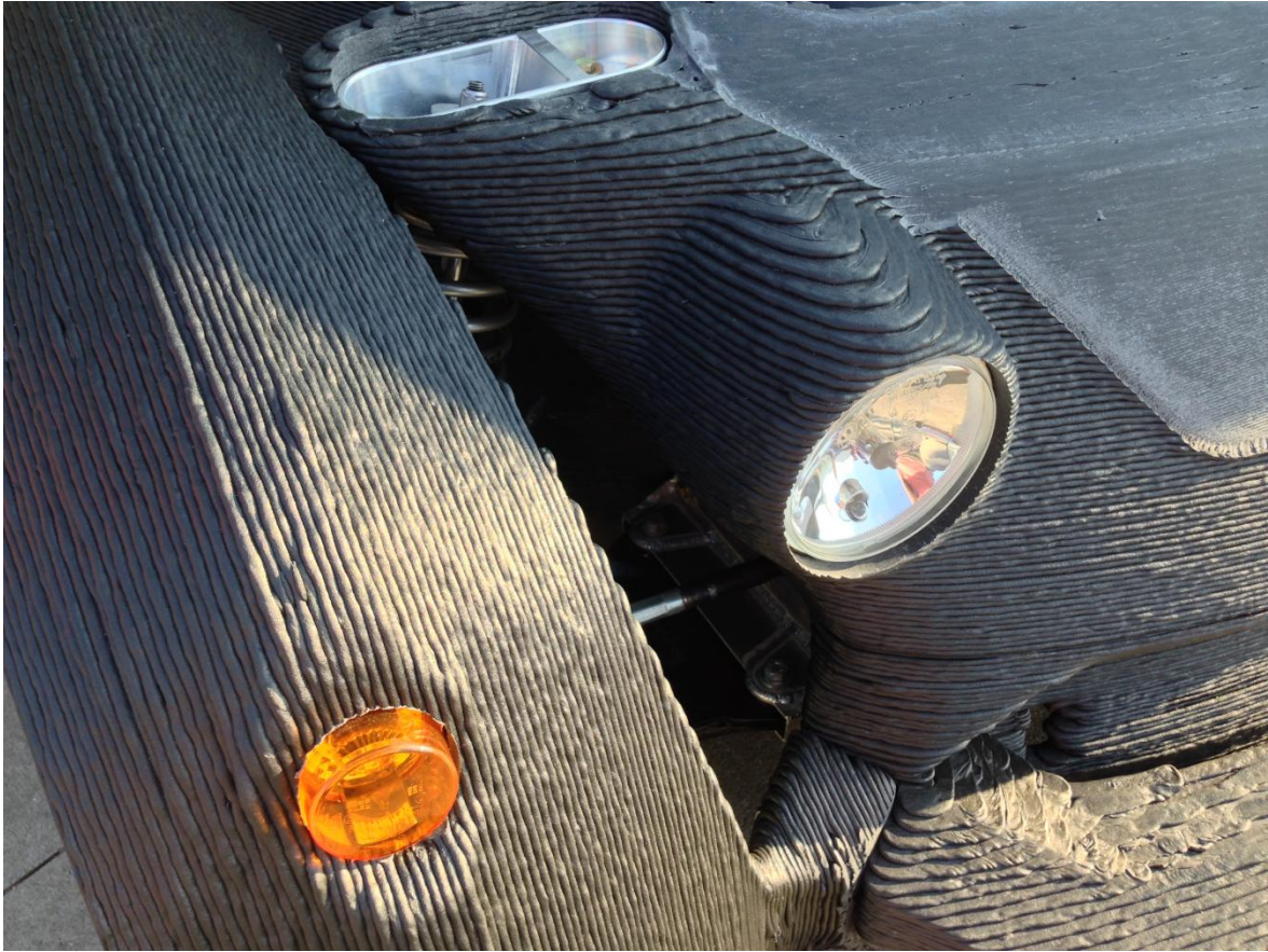
Slika 3: Strati, prvi 3D isprintani automobil
