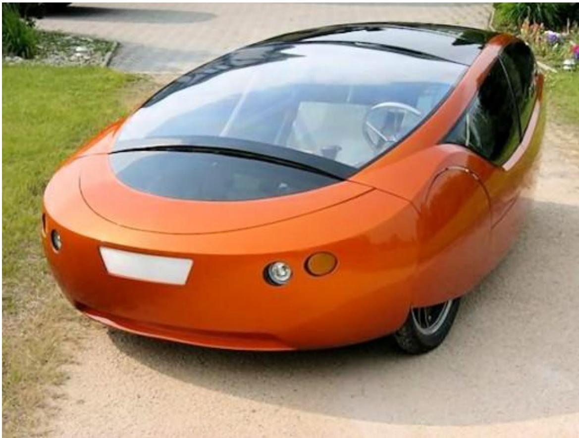
Slika 1: Urbee, prvi automobil s isprintanom karoserijom
