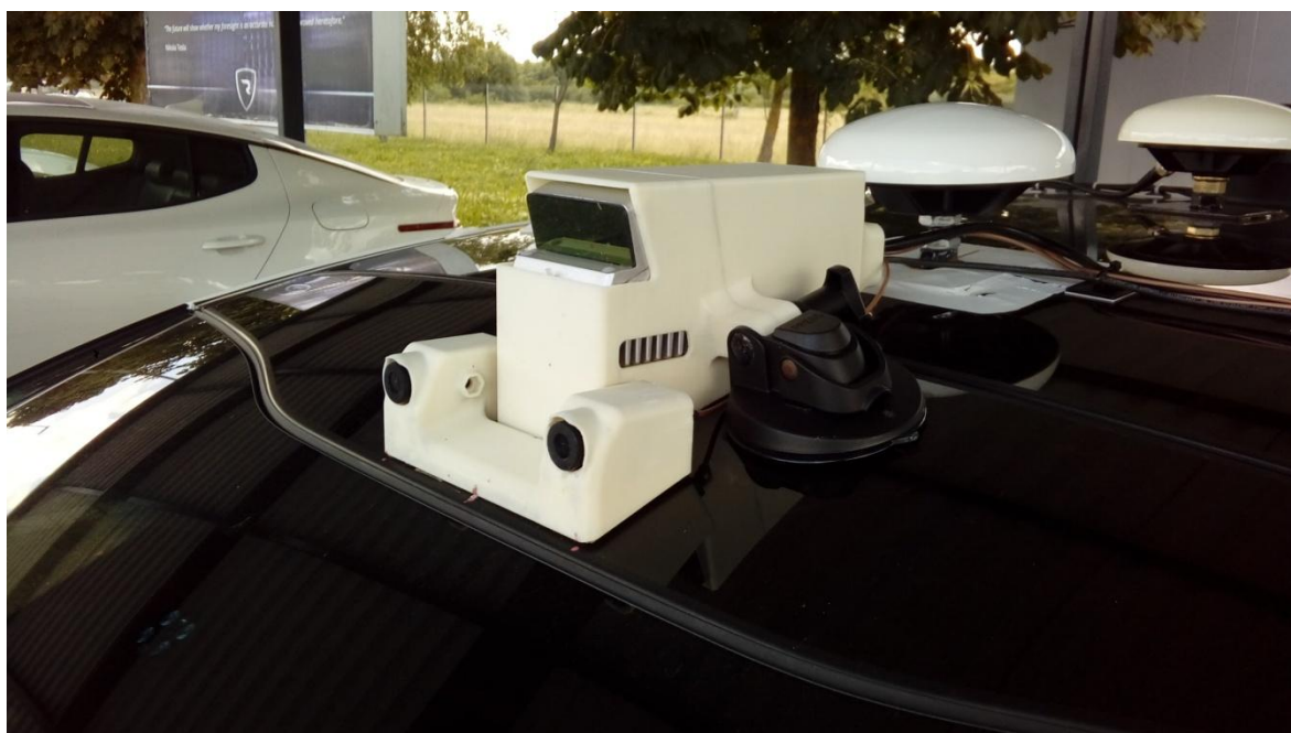
Slika 13: 3D isprintano kućište senzora
