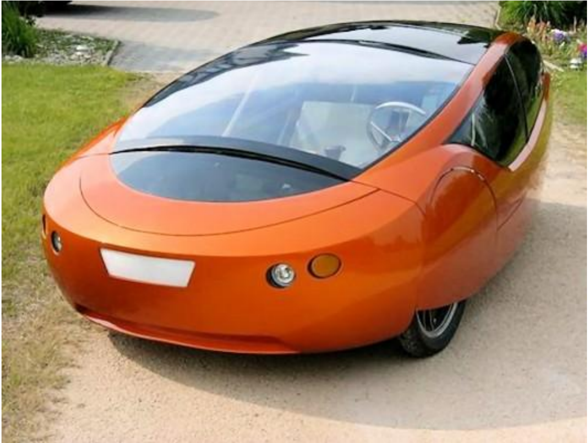
Slika 1: Urbee, prvi automobil s isprintanom karoserijom
