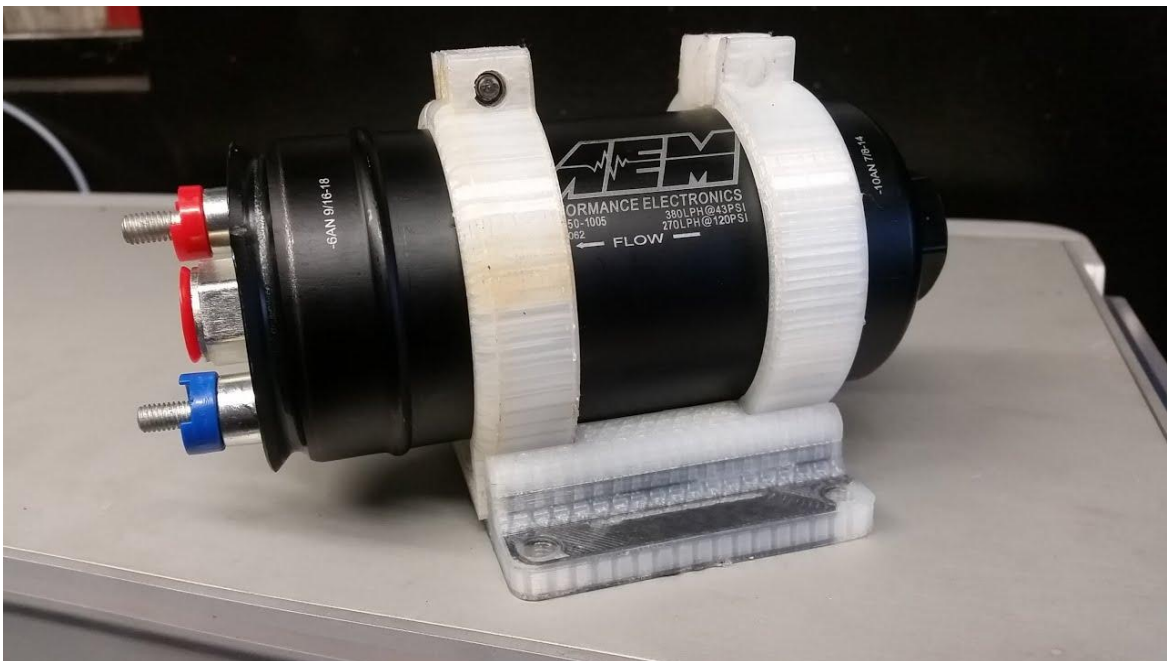
Slika 4: 3D isprintan automobilski dio
