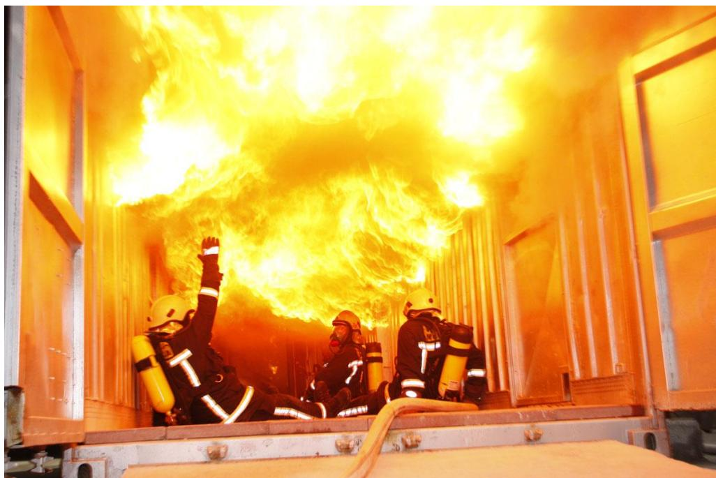
*Slika 4.2 Simulator plamenih udara na kruta goriva
