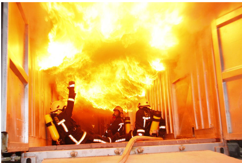
Slika 4.2 Simulator plamenih udara na kruta goriva Izvor: www.dvd-makarska.hr
