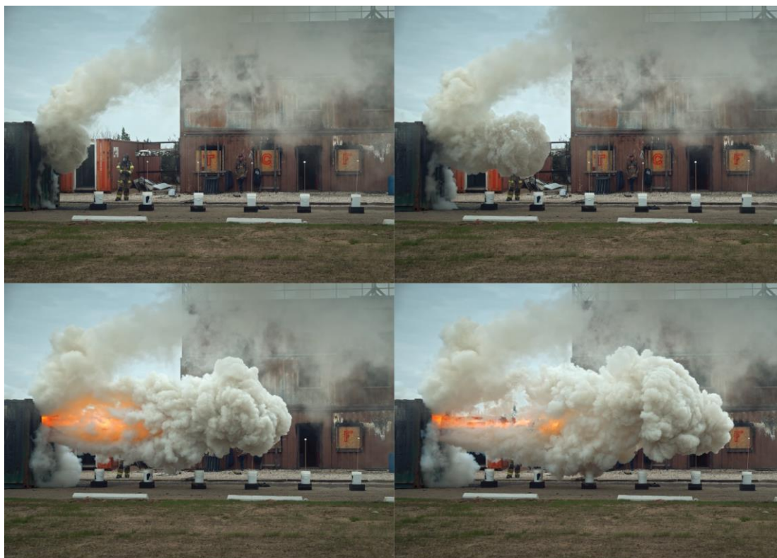
Slika 3.5 Prikaz backdraft-a Izvor: YouTube kanal
