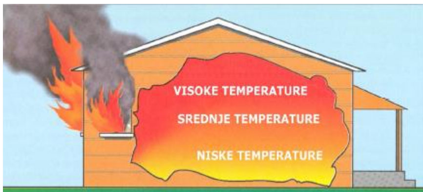
Slika 3.1 Odnos temperature pri požaru zatvorenog prostora
