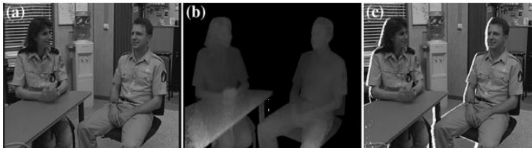
Slika 5.3 - Prikaz DIBR izobličene slike, gdje je a) referentna tekstura, b) referentna dubina, c) sintetizirani pogled.
