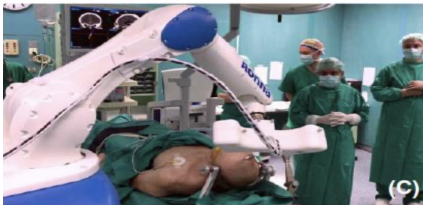
Slika 7.3.2. Planiranje sterotaksije pomoću RONNE. (Izvor: Dlaka D, Švaco M, Chudy D i sur. Brain biopsy performed with the RONNA G3 system)
