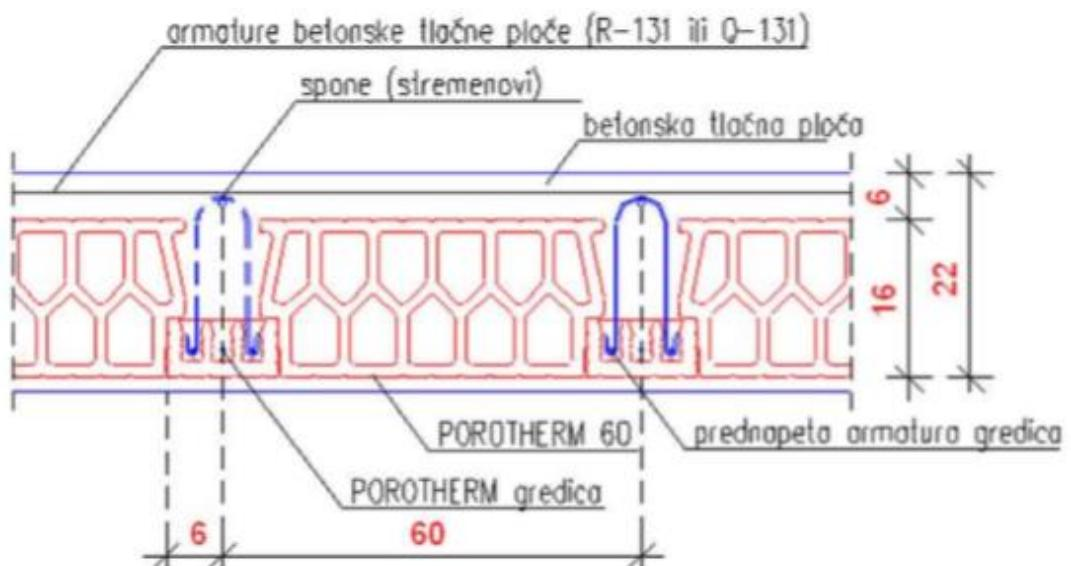
**Slika 3.12. Presjek porotherm međukatne konstrukcije iznad 1. Kata**
