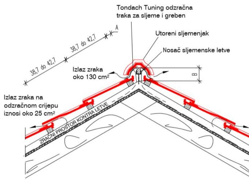
Slika 3.20. Presjek krova – detalj krova sa pokrovom od Tondach JUPITER crijeplom
