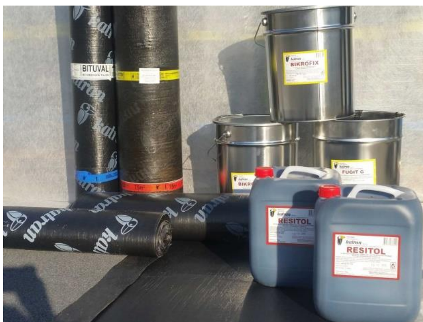
Slika 3.14. Hdroizolacija koju smo koristili na gradilištu
