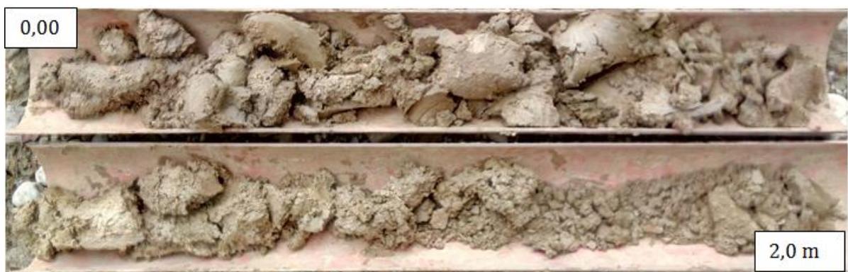
Slika 6.4. Nabušena jezgra bušotine B1
