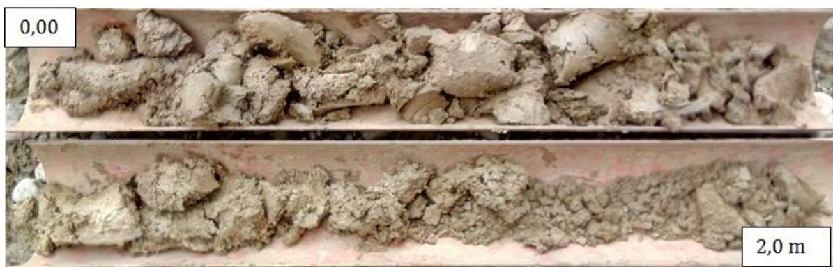
Slika 6.4. Nabušena jezgra bušotine B1
