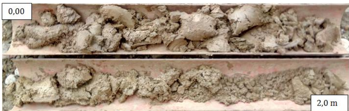
Slika 6.4. Nabušena jezgra bušotine B1
