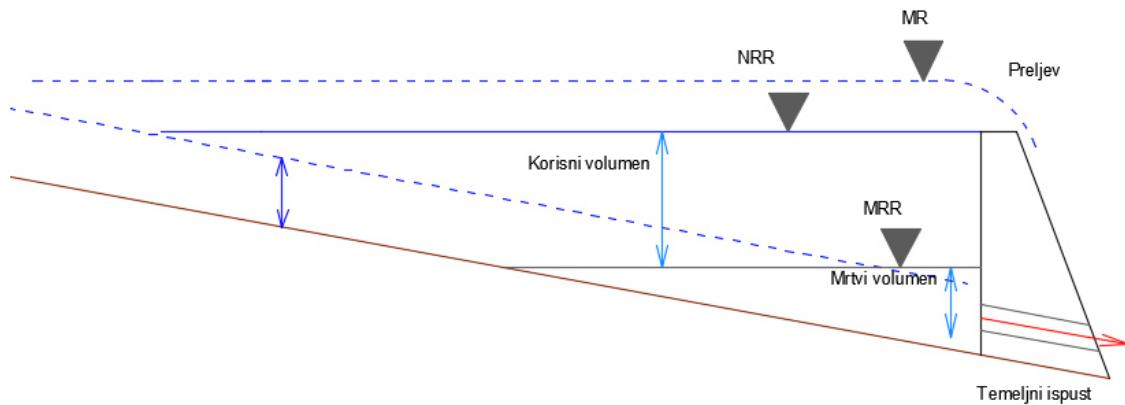
Slika 2.1 Shematski prikaz osnovnih parametara akumulacije [13]
