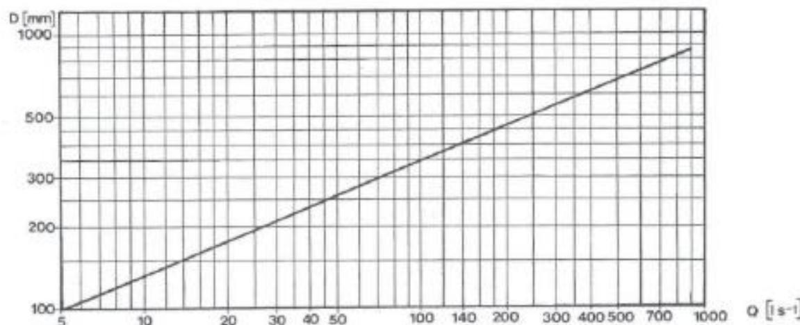
Slika 4.1. Dijagram ovisnosti unutarnjeg promjera cjevovoda i protoka
