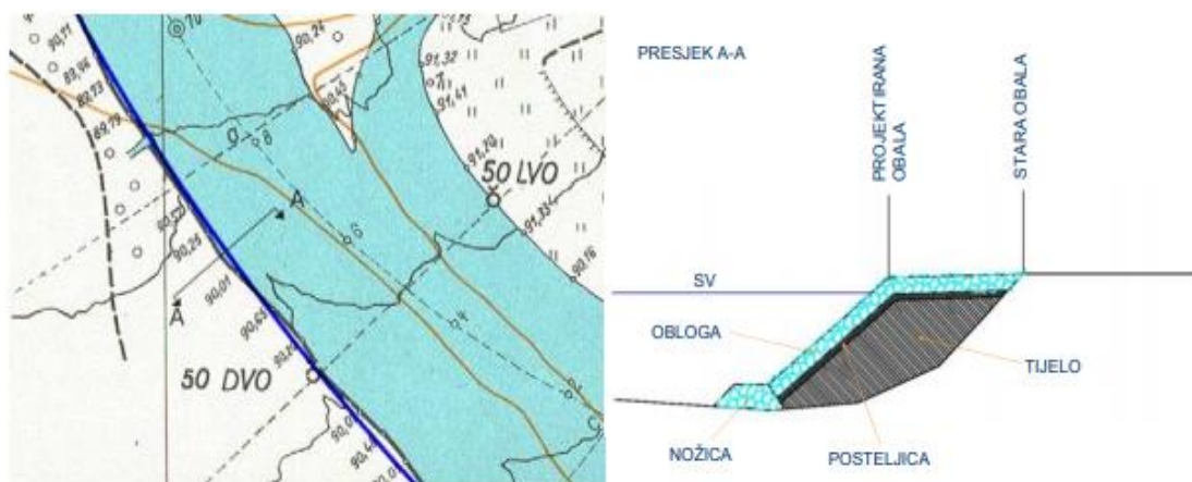
Slika 2.2. Shematski prikaz obaloutvrde [6]
