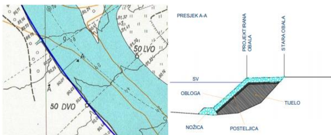
Slika 2.2. Shematski prikaz obaloutvrde [6]
