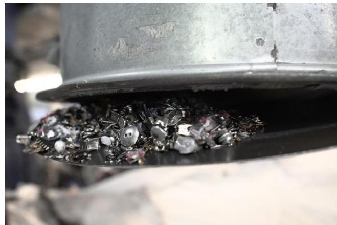
*Slika 5.6: Posebno odstranjivanje metalnih dijelova*
