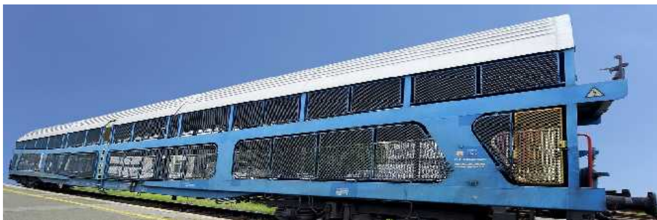
Slika 7.1.2.1. Vagon serije MDDL, izvor: http://www.hzpp.hr/serija-mddlm?p=7356
