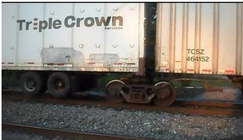
Slika 10.2.1. Bimodalna tehnologija , izvor: https://www.youtube.com/watch?reload=9&v=Xhcf_m6AKK8
