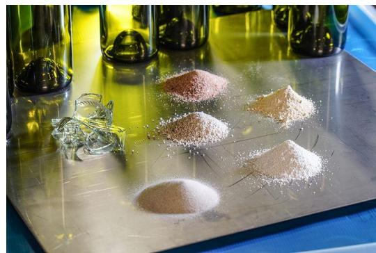
Slika 11. Sirovine za proizvodnju ambalažnog stakla
