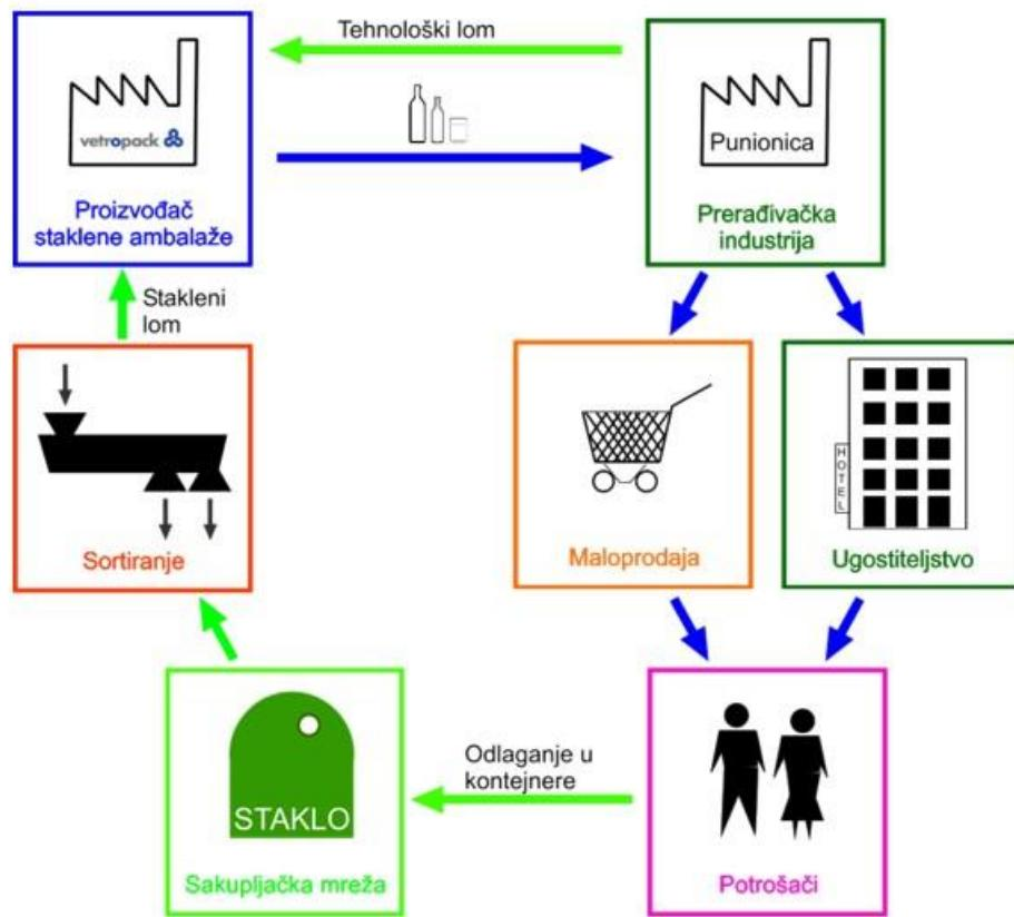
*Slika 6. Kružni tok ambalažnog stakla*
