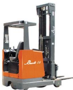
Slika 8. Viličar sa uvlačnim jarbolom
