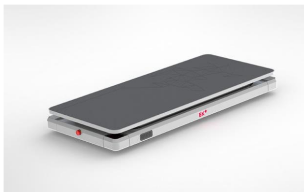
Slika 40. Ultra ravan transportni robot FAST MOVE
