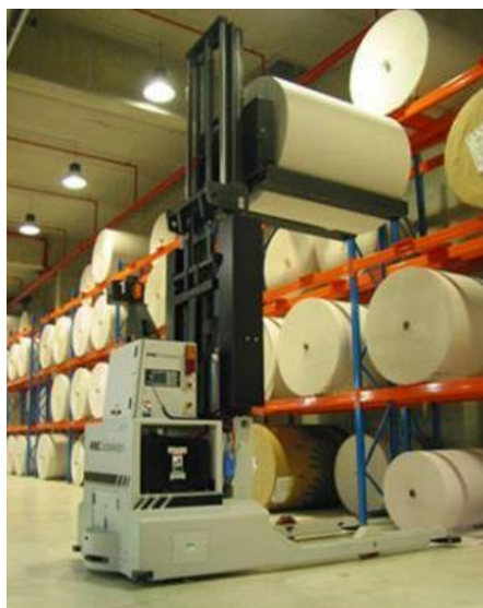
Slika 37. AGV vozilo (viličar) u procesu uskladištenja papira
