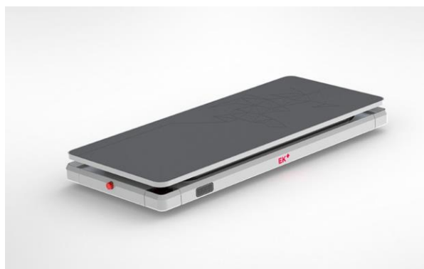
Slika 40. Ultra ravan transportni robot FAST MOVE
