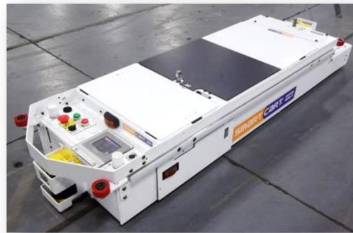
Slika 34. AGV vozilo jediničnih tereta
