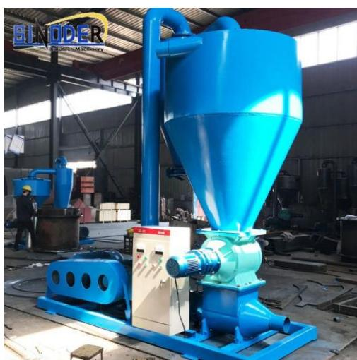
Slika 31. Pneumatski konvejer (elevator) za žitarice
