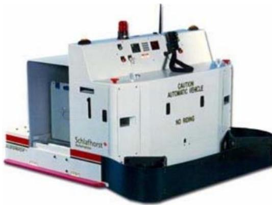
Slika 33. Vučno AGV vozilo
