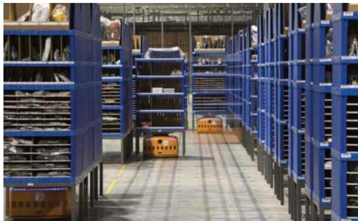
Slika 39. Prikaz skladišta sa podnim KIVA AGV vozilom
