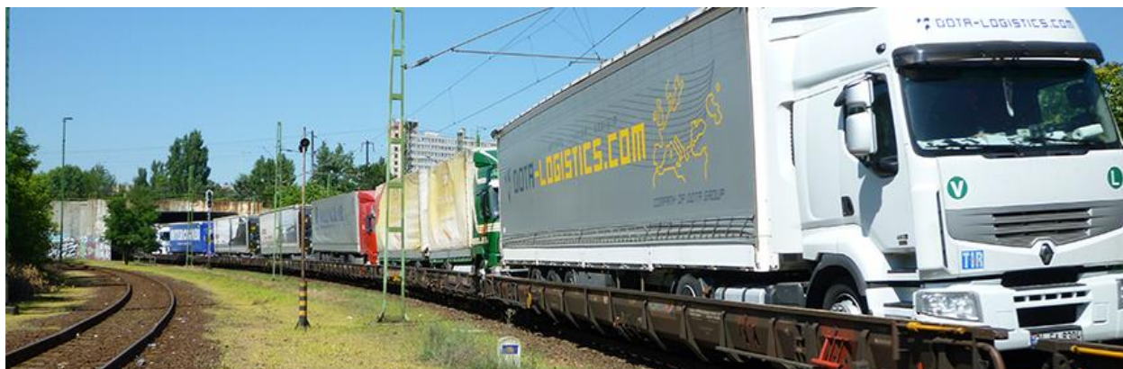
Slika 8. Huckepack tehnologija A
