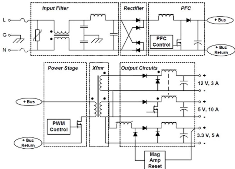
Slika 2.7. Funkcionalni blok dijagram napajanja AC/DC pretvarača [1]
