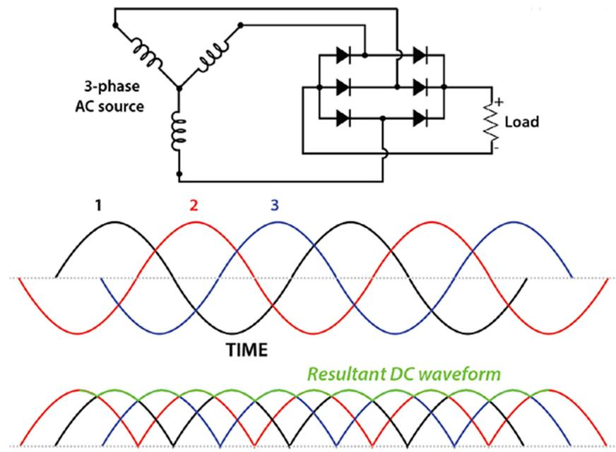
Slika 2.11. 3-fazni punovalni ispravljač i DC izlaz [2]
