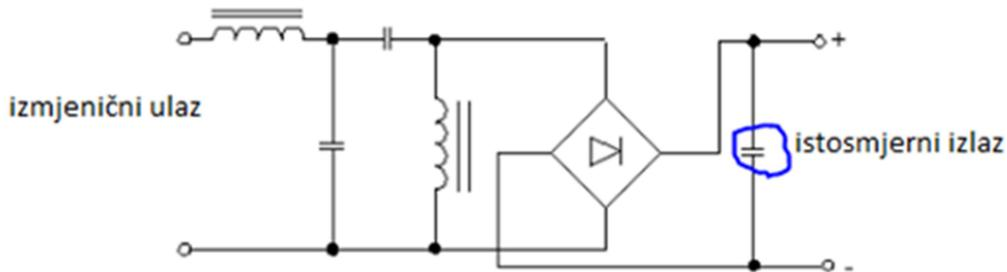
Slika 2.12. Dodavanje kondenzatora za pasivni PFC [18]
