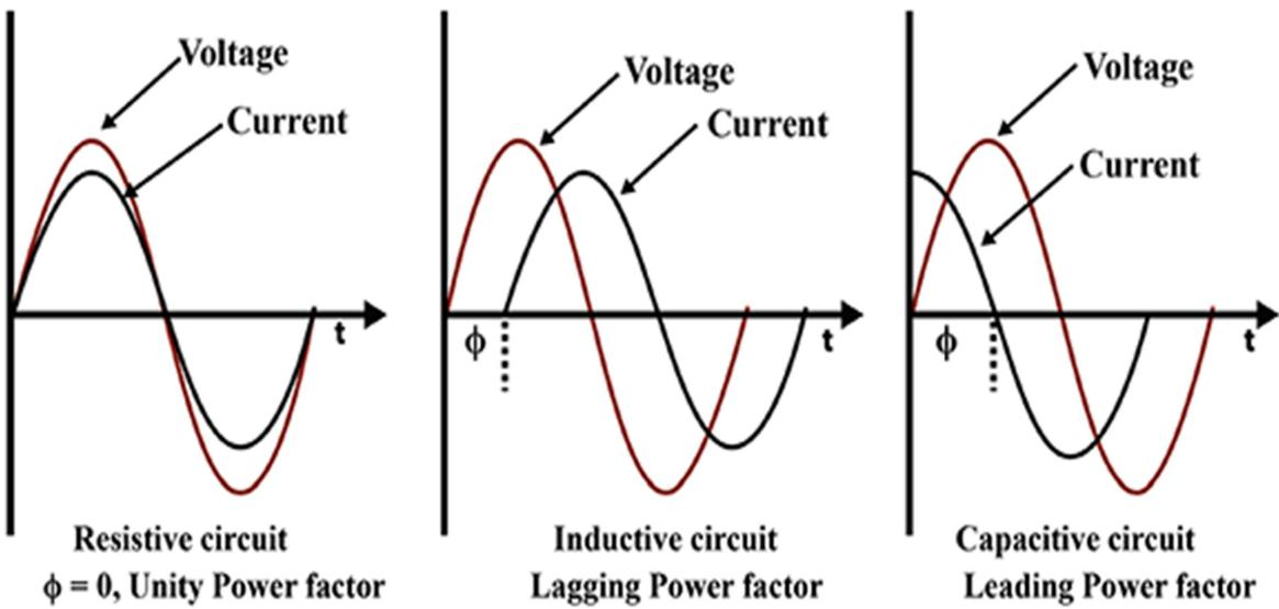
*Slika 2.8. Otpornički, induktivni i kapacitivni krug [2]*
