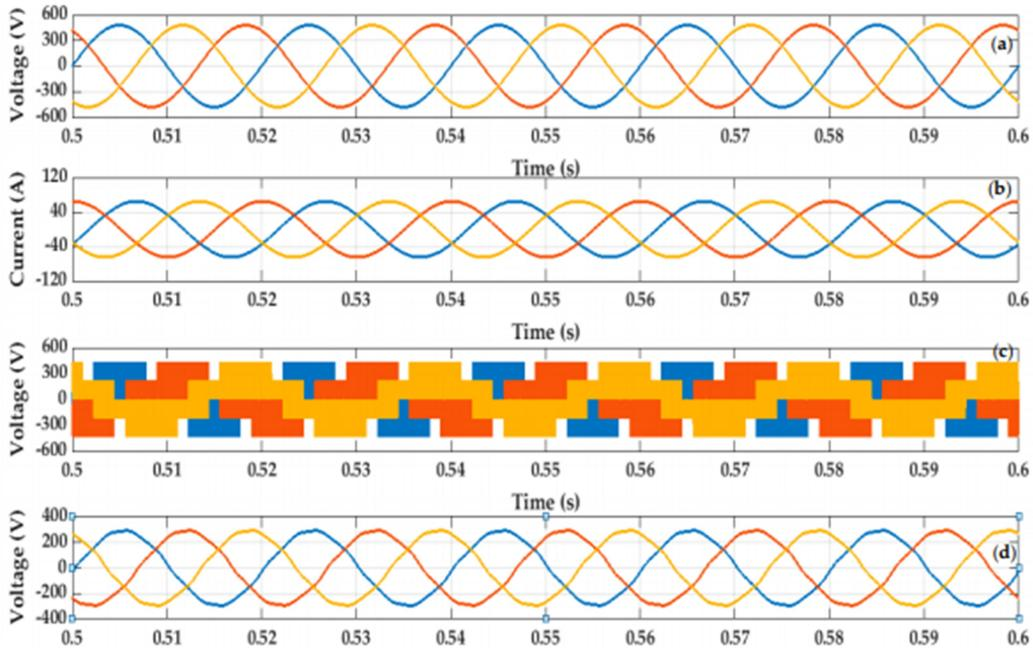
Slika 4.2. Simulacijski valni oblici vučenog napona i struje od mreže do stanice za punjenje:
