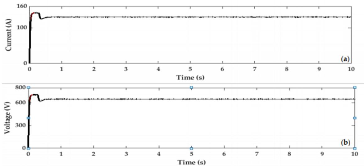
Slika 4.5. Valni oblici struje i napona istosmjernog brzog punjenja: (a) struja, (b) napon [8]
