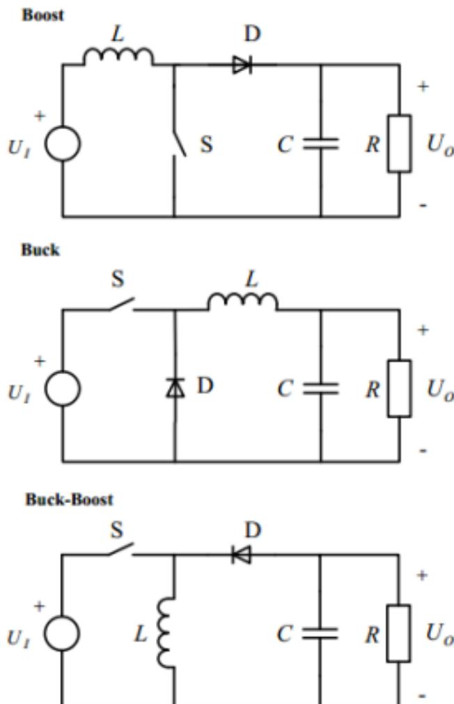
Slika 3. 2. Prijenosne karakteristike DC/DC pretvarača
