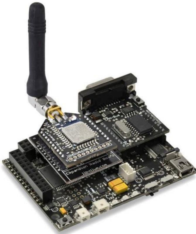
*Slika 5.10. CAN modul sa dodatnom radio pločicom [16].*
