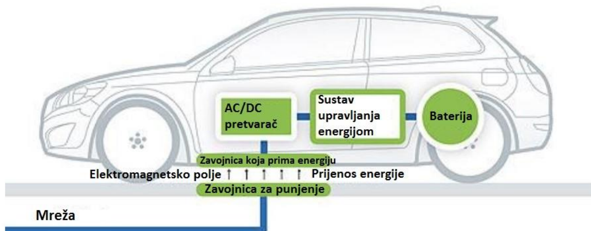
Slika 3.6. Bežično (indukcijsko) punjenje [1].
