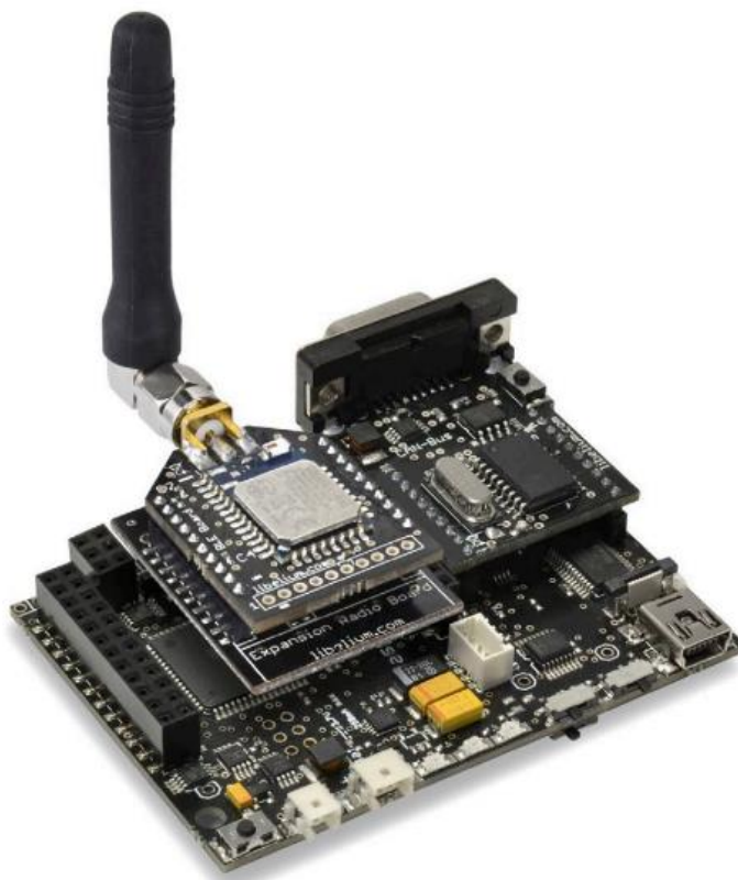
Slika 5.10. CAN modul sa dodatnom radio pločicom [16].
