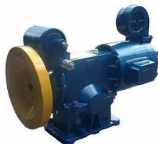
Slika 4.3 Reduktorski (asinkroni) motor za dizalo [10]
