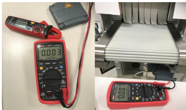
Slika 4.7 Mjerni instrument digitalni multimetar i strujna kliješta marke LINI-T
