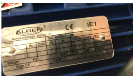
Slika 4.6 Natpisna pločica asinkronog motora ulaznog transportera
