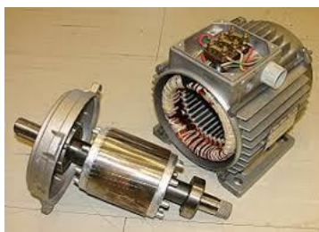
Slika 2.5 Primjer asinkronoga motora s kaveznim rotorom [6]
