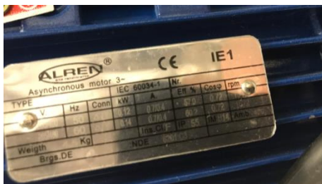
Slika 4.6 Natpisna pločica asinkronog motora ulaznog transportera
