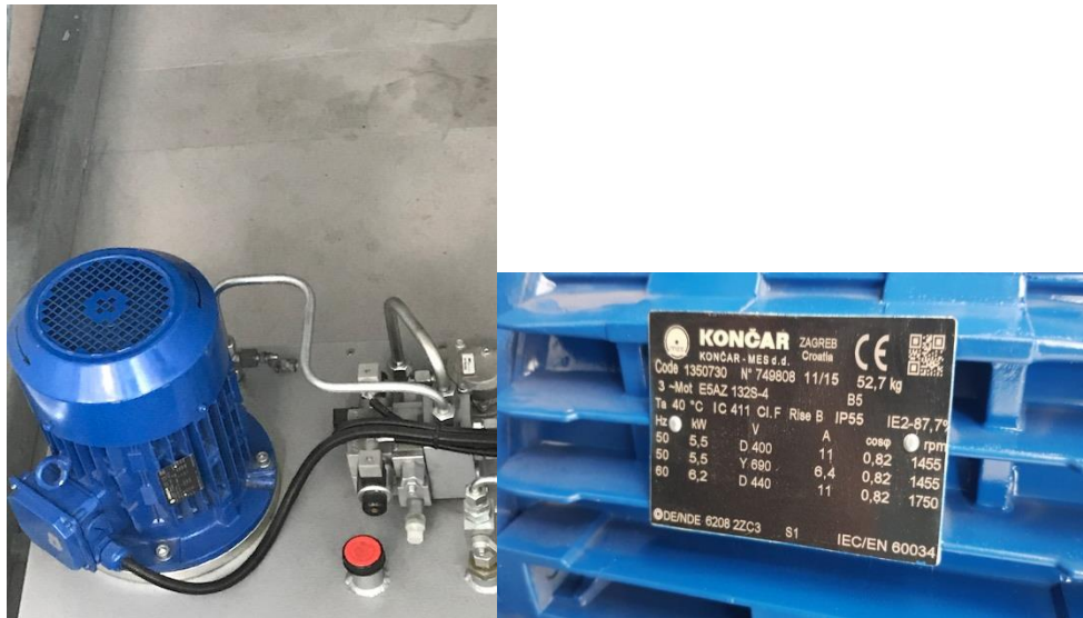
Slika 4.2 Elektromotor za pogon škaraste platforme
