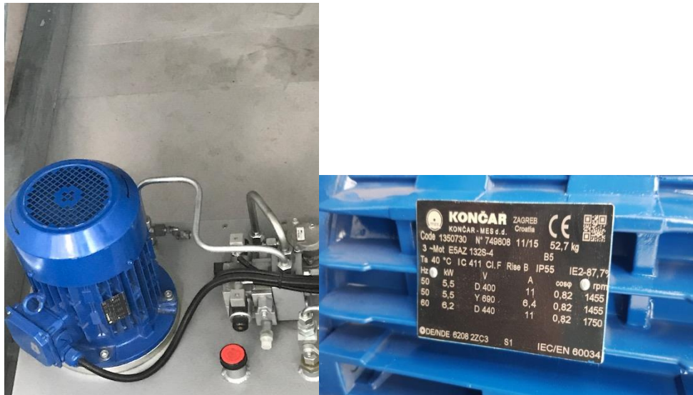
Slika 4.2 Elektromotor za pogon škaraste platforme
