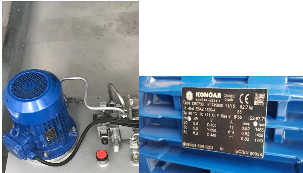
Slika 4.2 Elektromotor za pogon škaraste platforme
