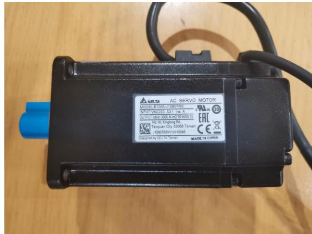
*Slika 3.5 Servo motor s natpisnom pločicom*
