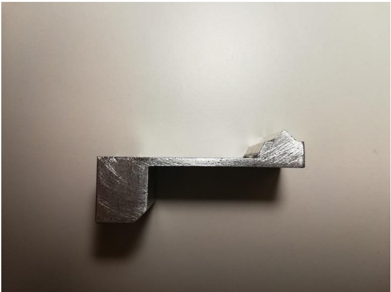
Slika 2.6 mjerni element manjeg promjera načinjen od aluminija
