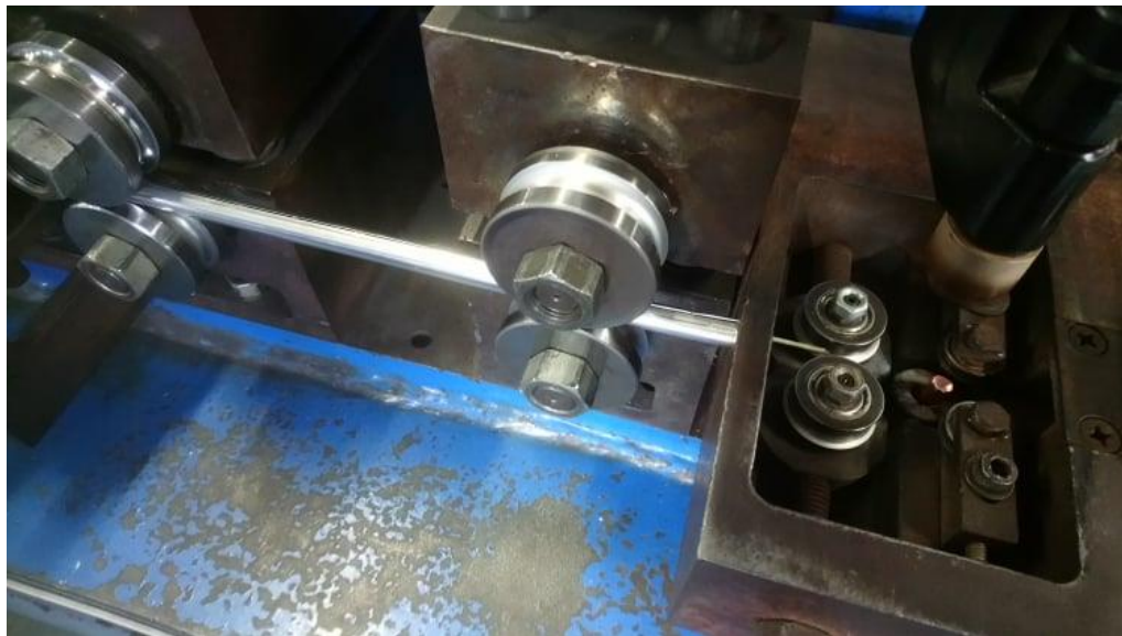
Slika 27 Savijena traka u cijev, ulaz u konzolu za zavarivanje
