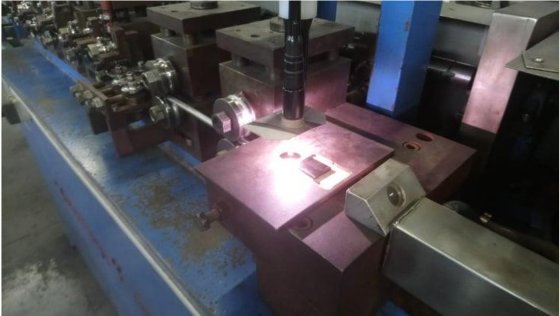
Slika 25 Paljenje pištolja za plazma zavarivanje
