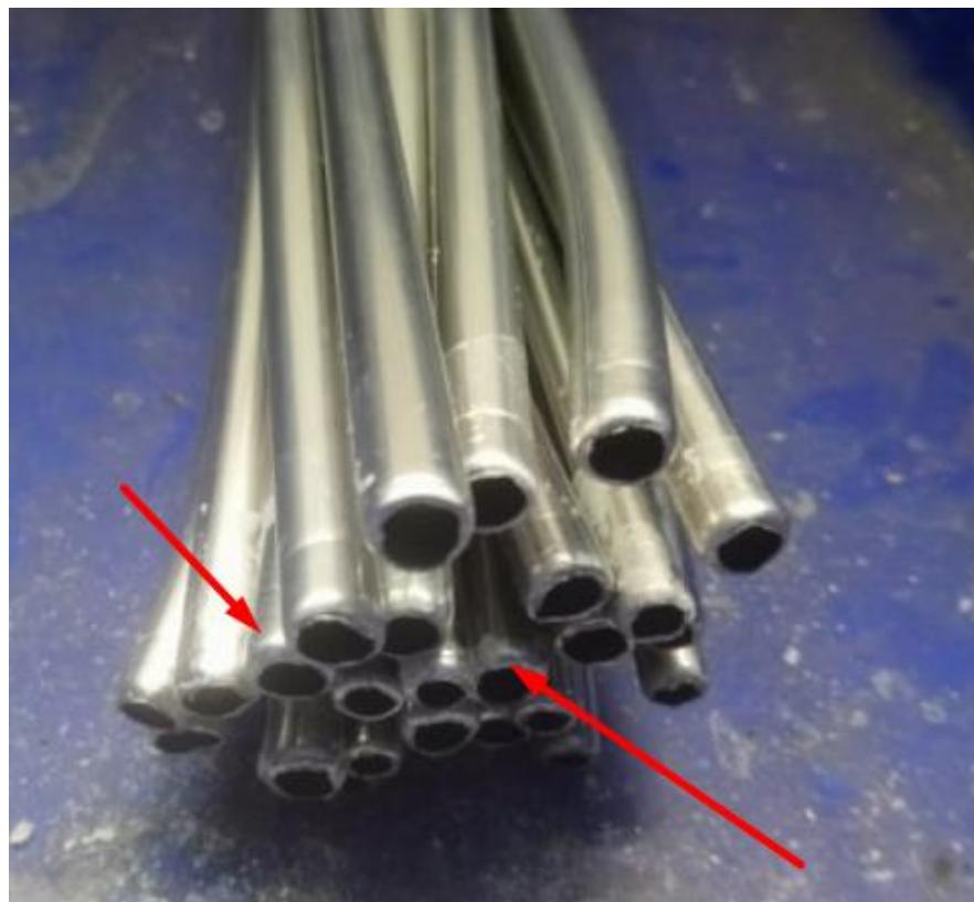
Slika 38 Ispitni uzorci nakon ispitivanja u vodenoj otopini natrijevog klorida
