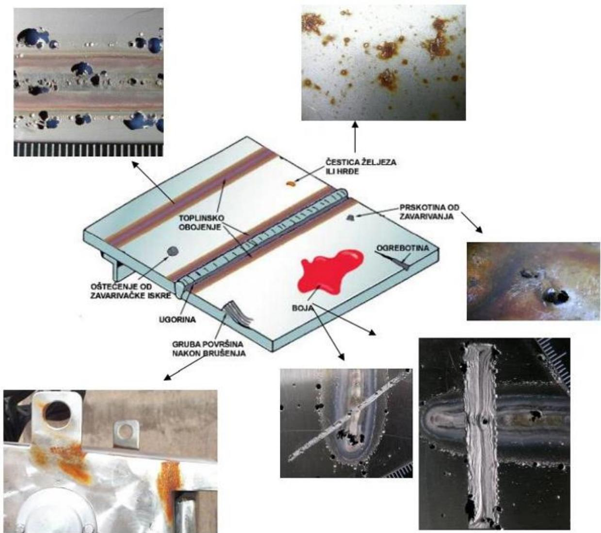
Slika 3 Prikaz posljedica pojedinih karakterističnih nehomogenosti površine [2]
