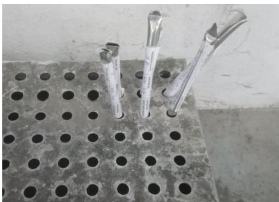
Slika 37 Ispitivanje cijevi u vodenoj otopini natrijevog klorida
