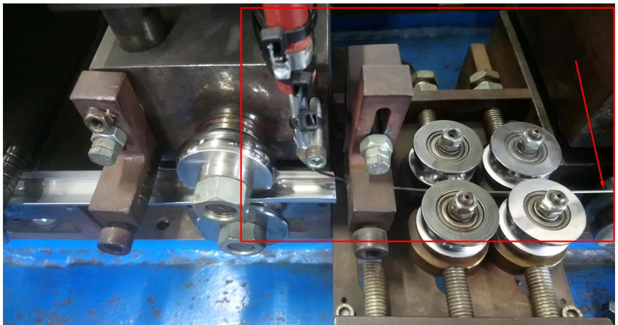
Slika 26 Dovod zaštitnog plina u unutrašnjost cijevi
