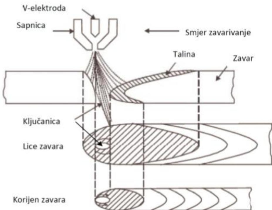
Slika 18 Shematski prikaz plazma zavarivanja ključanicom [18]
