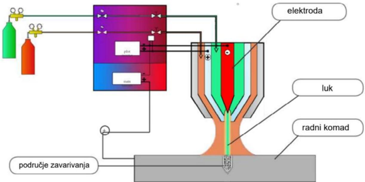
Slika 17 Funkcionalni dijagram plazma zavarivanja taljenjem [25]
