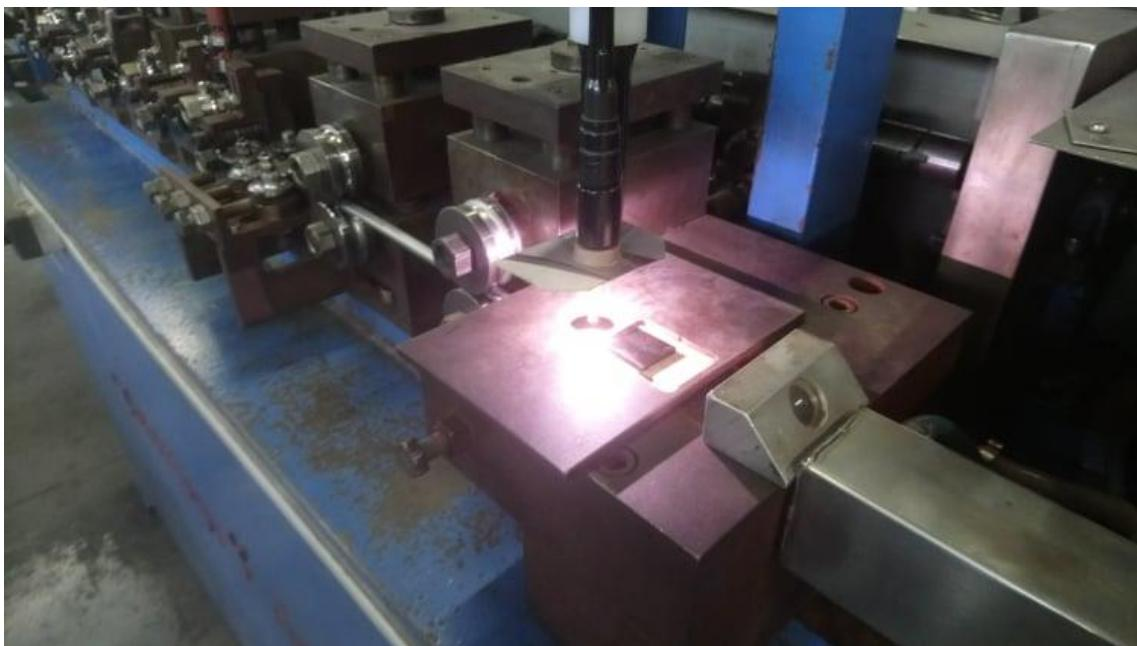
Slika 25 Paljenje pištolja za plazma zavarivanje
