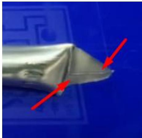
Slika 34 Vizualna kontrola zavora nakon zavarivanja
