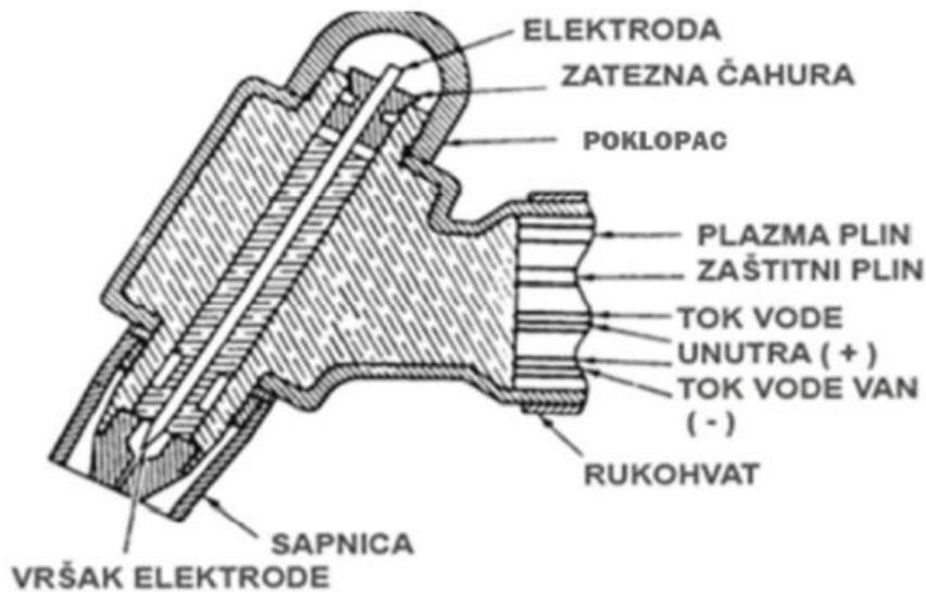
Slika 11 Poprečni presjek pištolja za plazma zavarivanje [17]
