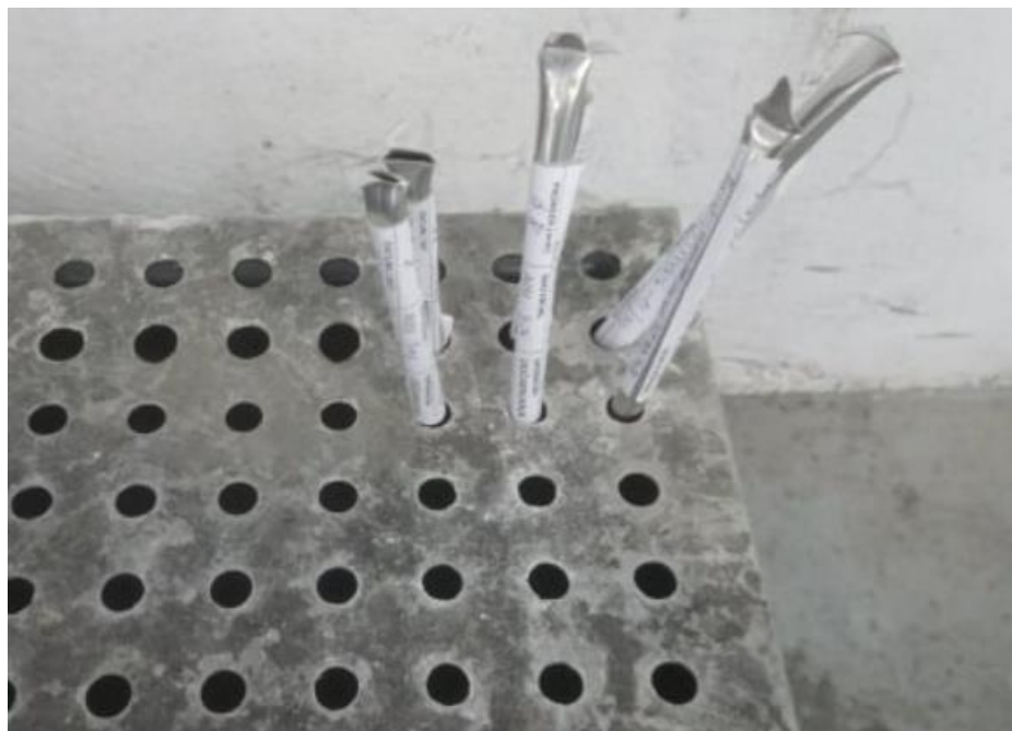
Slika 37 Ispitivanje cijevi u vodenoj otopini natrijevog klorida
