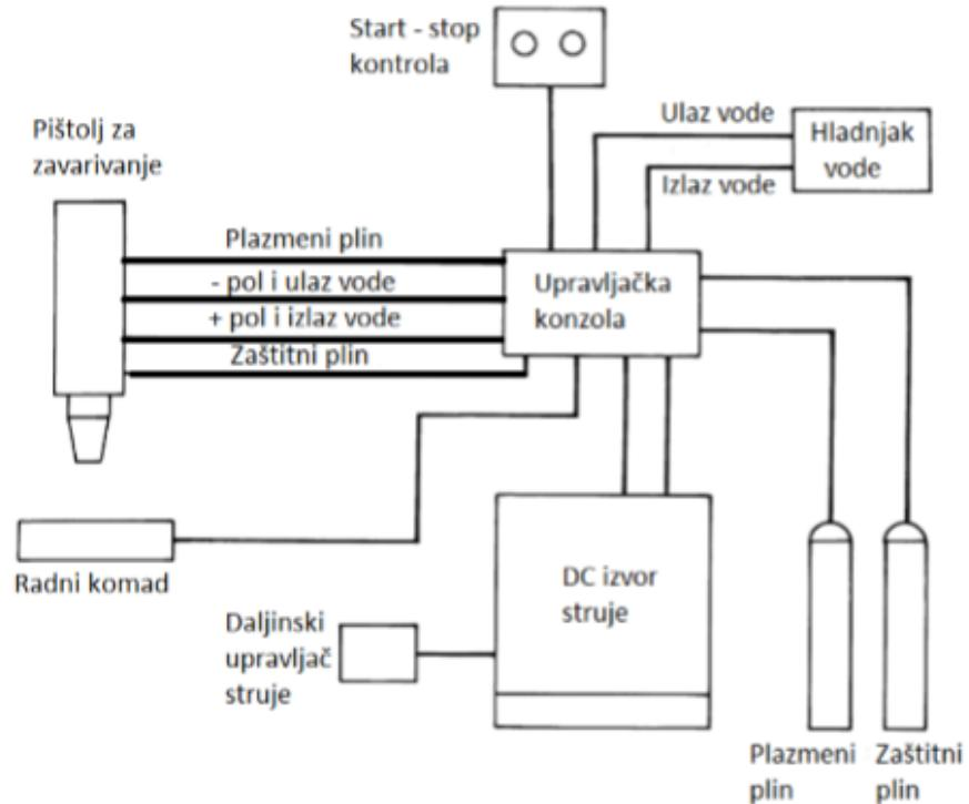
Slika 10 Oprema za plazma zavarivanje [13]
