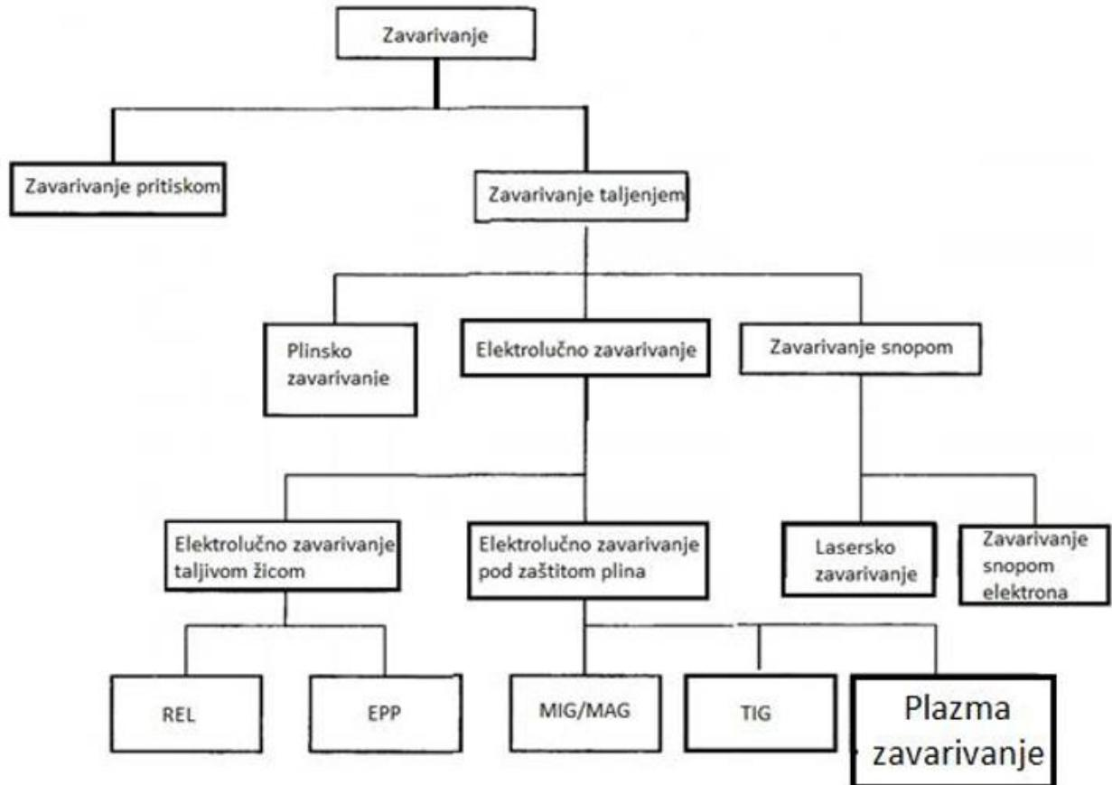
Slika 8 Shematski prikaz postupaka zavarivanja taljenjem [13]
