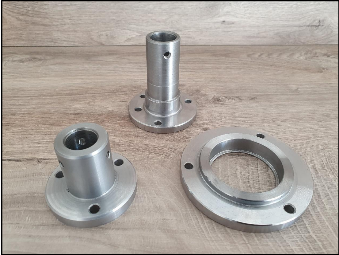
Slika 4.20 Dijelovi nakon tokarenja
