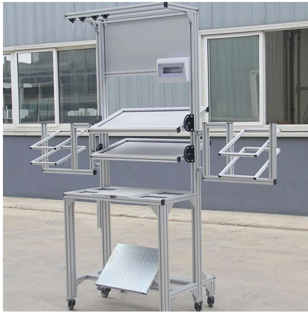
Slika 4.8 Primjer upotrebe strukturnih aluminijskih profila
