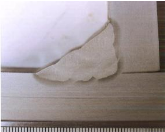
Slika 11.19. i 11.20. Makroizbrusci ispitnog uzorka kutnog spoja
