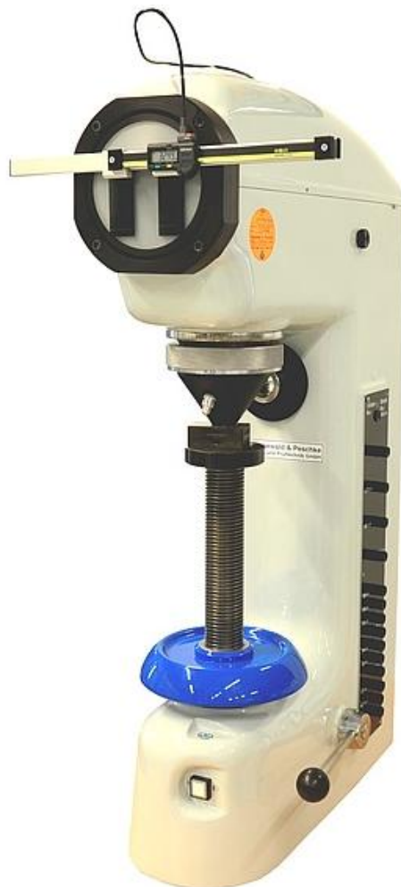
Slika 11.16. Uređaj za mjerenje tvrdoće (tvrdomjer) HPO-250[19]
