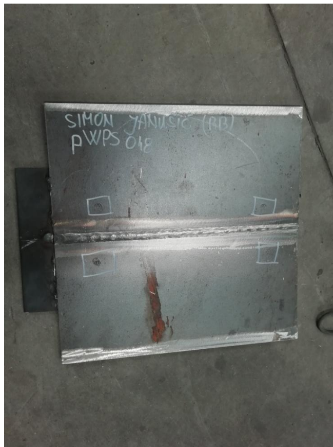
Slika 9.6. Zavaren ispitni uzorak sučeljenog spoja
