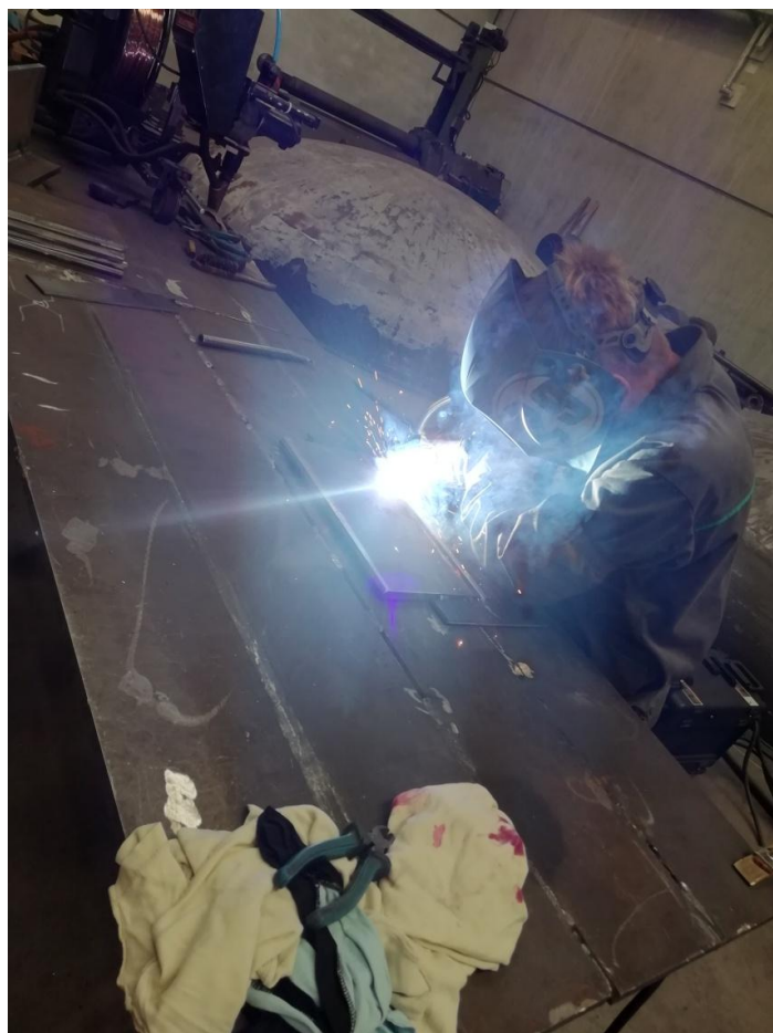
Slika 9.3. Zavarivanje popune sučeljenog spoja u PA položaju
