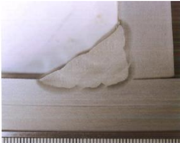
Slika 11.19. i 11.20. Makroizbrusci ispitnog uzorka kutnog spoja
