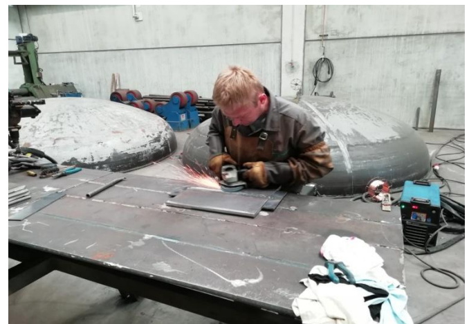
Slike 9.11. i 9.12. Međuslojno čišćenje brušenjem
