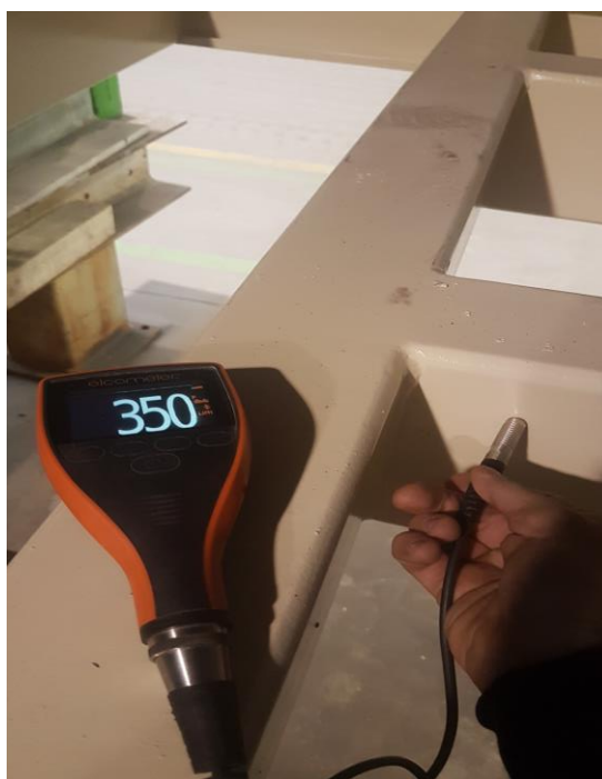
Slika 4.6 Uređaj za mjerenje debljine premaza
