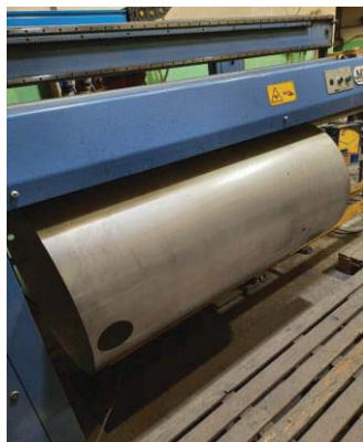
Slika 46. Postupak uzdužnog zavarivanja plašta
