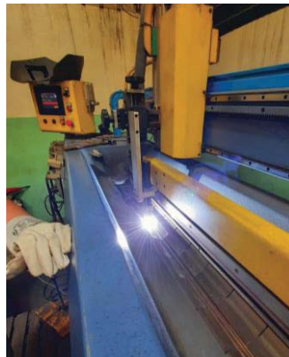
Slika 46. Postupak uzdužnog zavarivanja plašta
