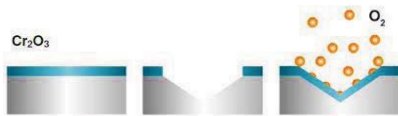
Slika 1. Prikaz mehanizma samoobnavljanja pasivnog filma kromovih oksida na površini
