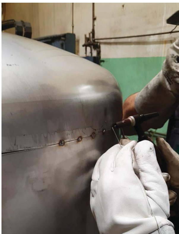
Slika 50. Pripajanje i zavarivanje podnica na plašt
