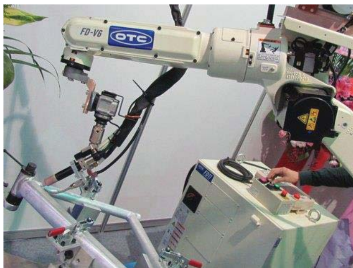
Slika 13. Robotsko TIG zavarivanje
