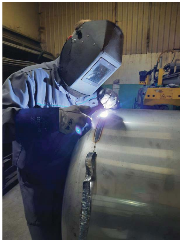
Slika 50. Pripajanje i zavarivanje podnica na plašt
