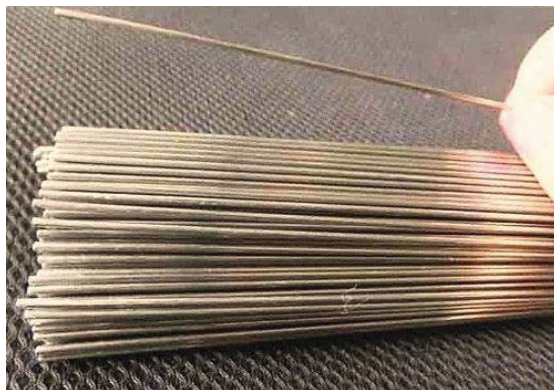
Slika 45. Dodatni materijal EZ - TIG 316 LSi
