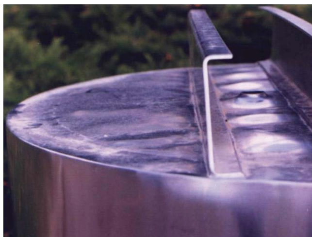
Slika 7. Deformacije nastale uslijed zavarivanja
