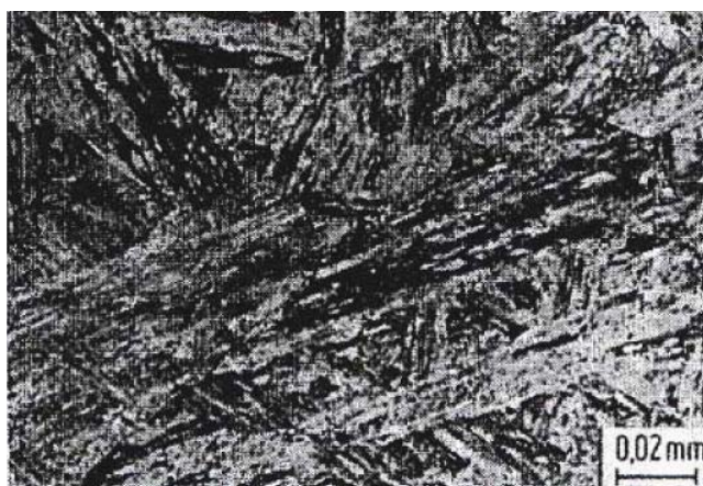
Slika 4. Martenzitna mikrostruktura nehrđajućih čelika
