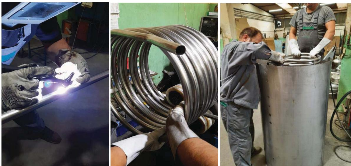
*Slika 49. Izrada i zavarivanje cijevnog izmjenjivača*
