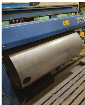
Slika 46. Postupak uzdužnog zavarivanja plašta
