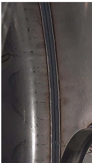
Slika 51. Korijen zavara plašta i podnice
