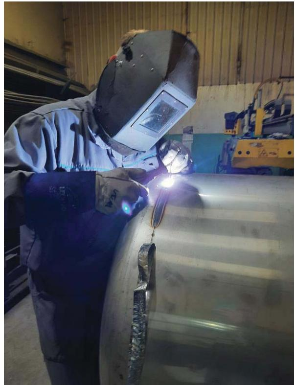
Slika 50. Pripajanje i zavarivanje podnica na plašt
