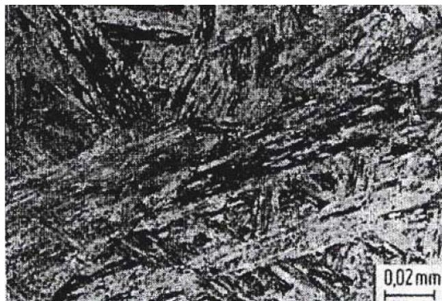
Slika 4. Martenzitna mikrostruktura nehrđajućih čelika
