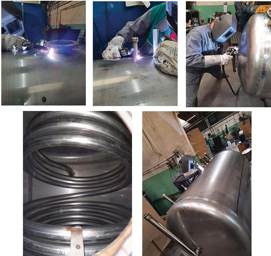
Slika 55. Zavarivanje prirubnice i priključaka na spremnik
