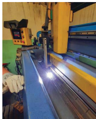
Slika 46. Postupak uzdužnog zavarivanja plašta
