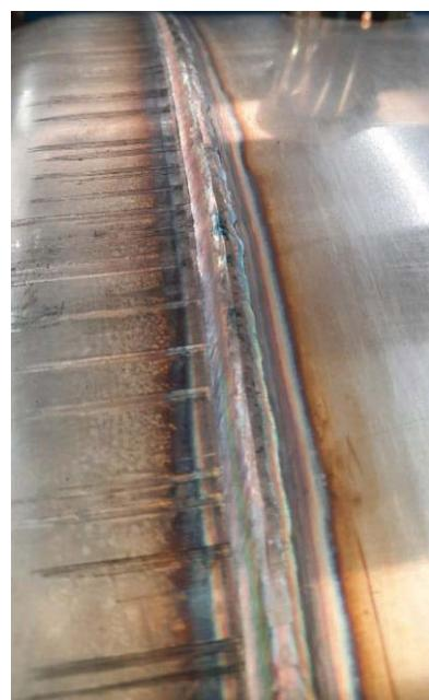
*Slika 52. Lice zavara plašta i podnice*
