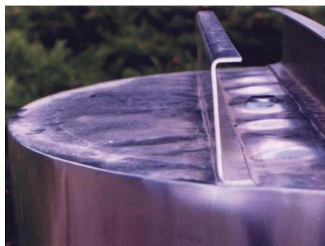
*Slika 7. Deformacije nastale uslijed zavarivanja*
