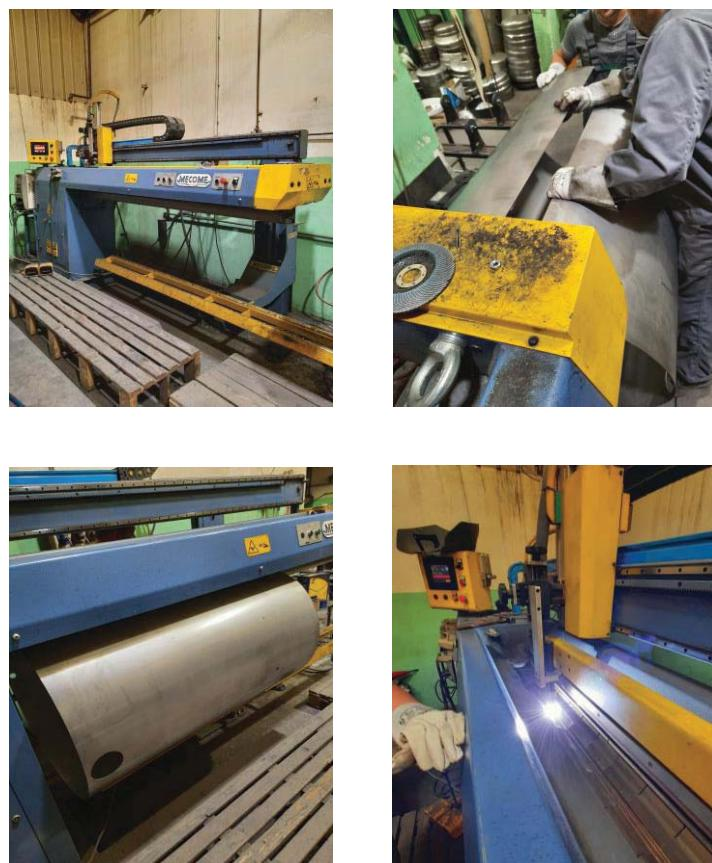
Slika 46. Postupak uzdužnog zavarivanja plašta
