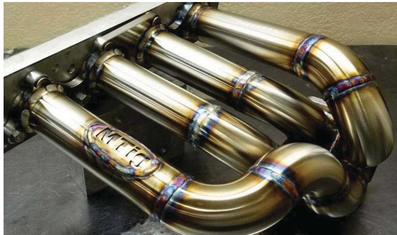
*Slika 14. Proizvod izveden TIG postupkom zavarivanja*
