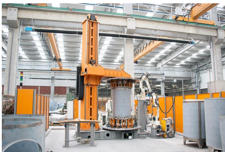
Slika 31. Roboti za lasersko zavarivanje plašta
