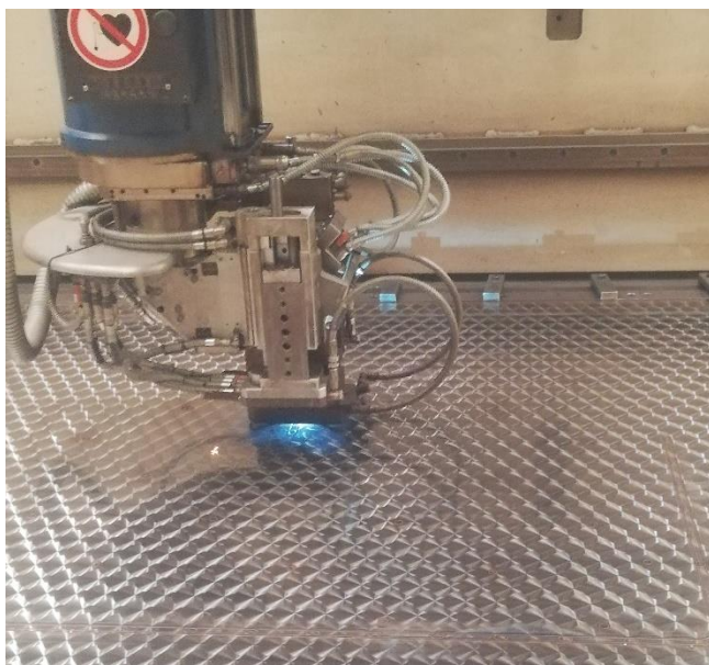
Slika 29. Lasersko zavarivanje duplikatora na Laser Cell-u 7040
