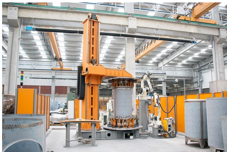
Slika 31. Roboti za lasersko zavarivanje plašta
