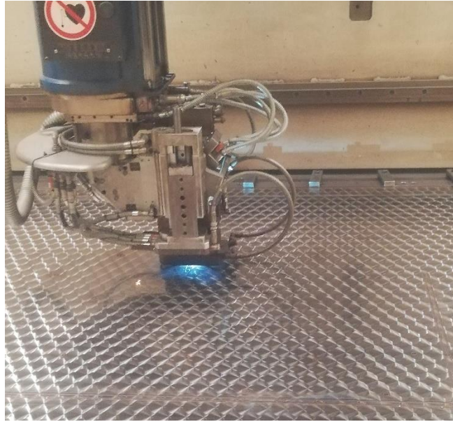
Slika 29. Lasersko zavarivanje duplikatora na Laser Cell-u 7040
