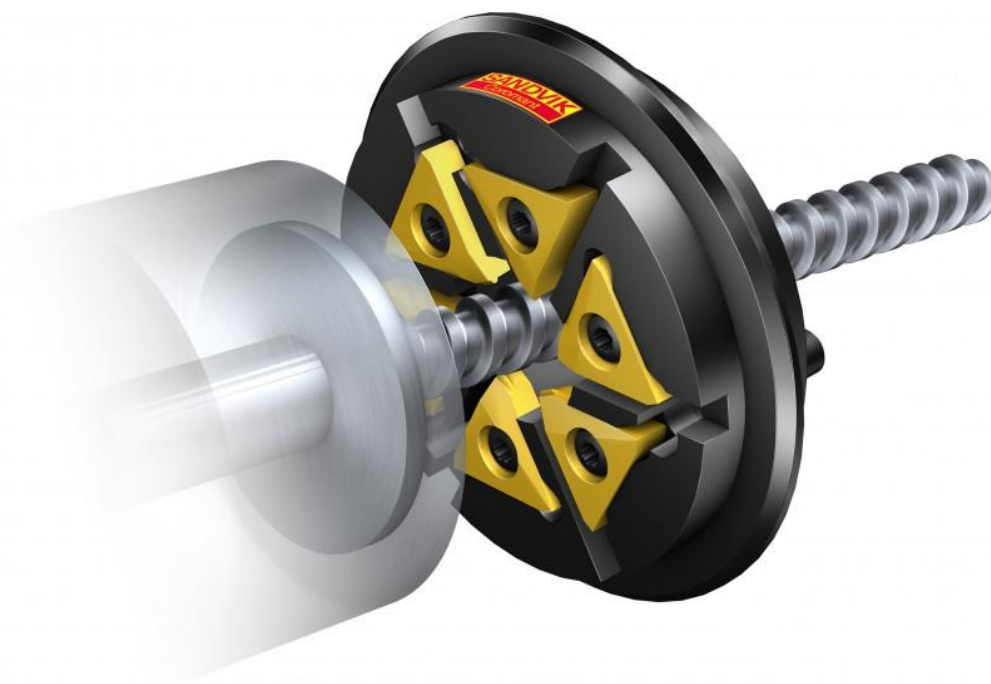
Slika 3.22 Izrada navoja češljastim noževima [20]
