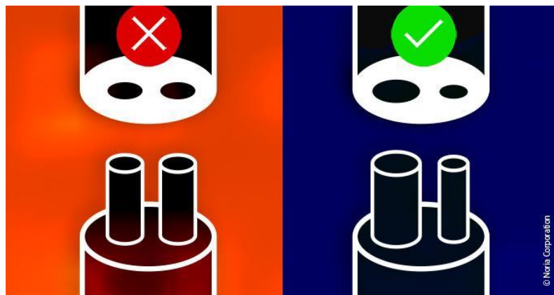
Slika 8. Primjer Poka-yoke metode [9]
