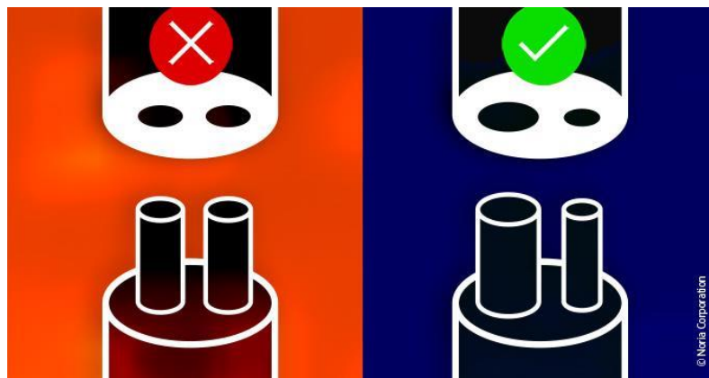
Slika 8. Primjer Poka-yoke metode [9]
