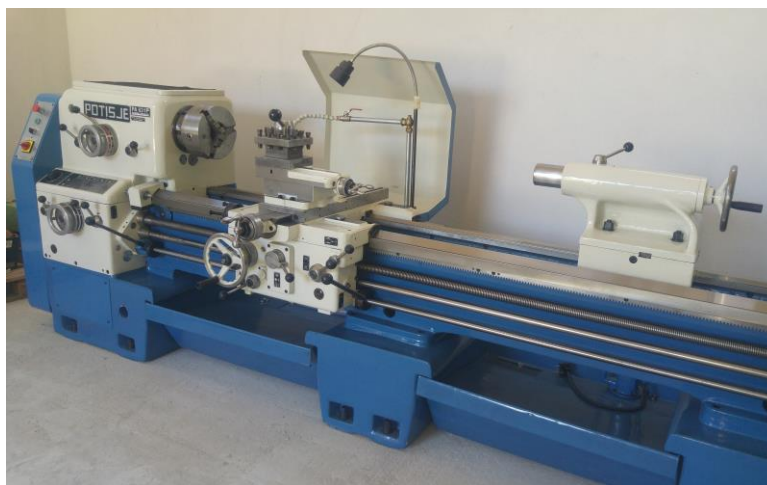
Slika 3.9 Tokarilica Potisje PA 631 [14]
