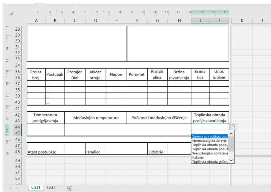
Slika 6. specifikacija postupka zavarivanja sa padajućim izbornicima (primjer 2)
