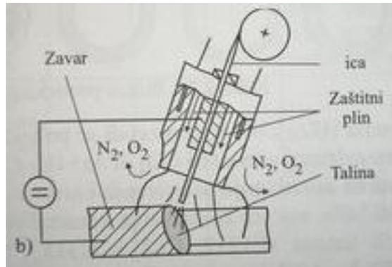
Slika 9. Shematski prikaz procesa MIG/MAG zavarivanja[14]
