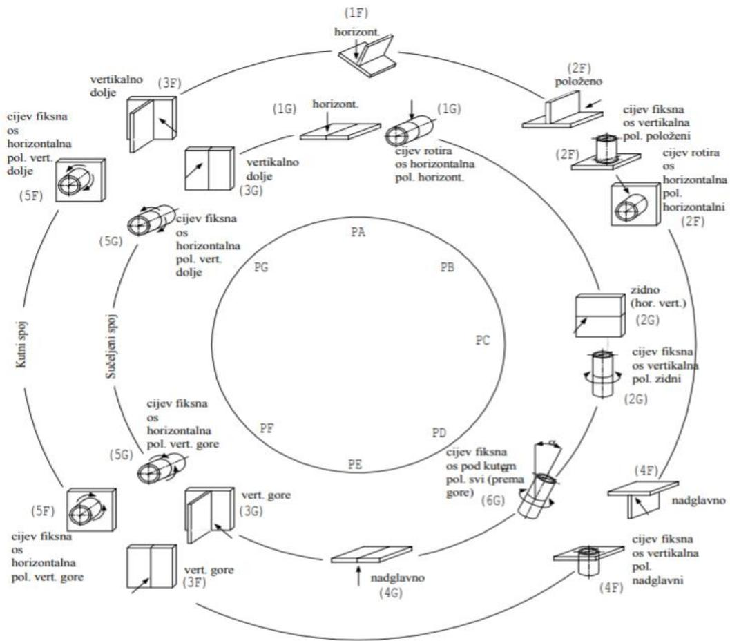
Slika 14. Prikaz položaja zavarivanja prema ASME i EN [9]
