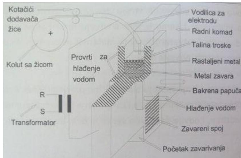
Slika 12. Shematski prikaz postupka zavarivanja pod troskom[15]
