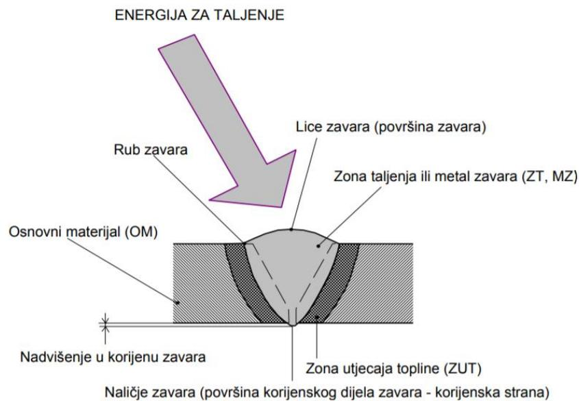
Slika 1. Zavarivanje taljenjem [15]
