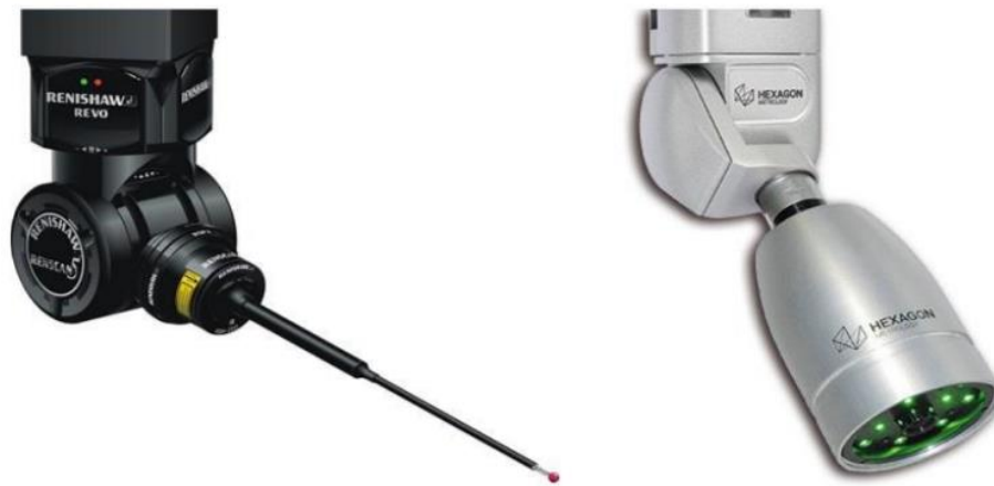
Slika 7. Senzori za koordinatne mjerne uređaje [7]
