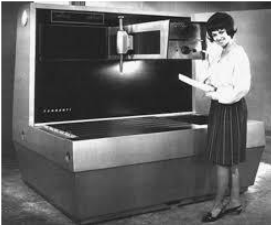
Slika 1. Prvi trokoordinatni mjerni uređaj [3]
