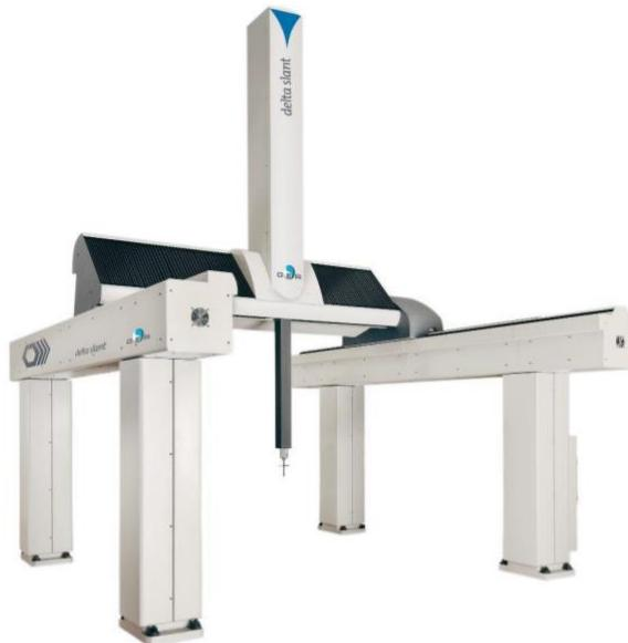
Slika 5. Portalni tip koordinatnog mjernog uređaja [5]
