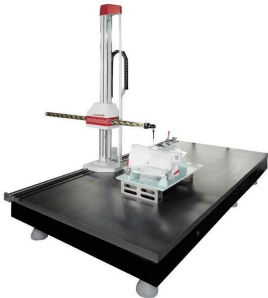
*Slika 4. Horizontalni tip koordinatnog mjernog uređaja [5]*
